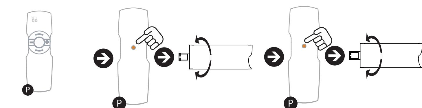
Modificar final de carrera- Limit position fine-tuning - Modification de la limite - Modifica fine corsa
