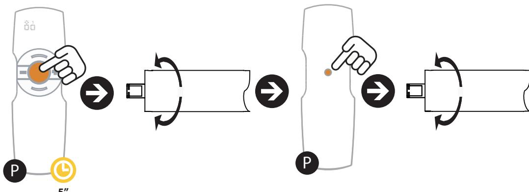
Reset del motor - Reset motor - Réinitialisation du moteur - Reset motore
