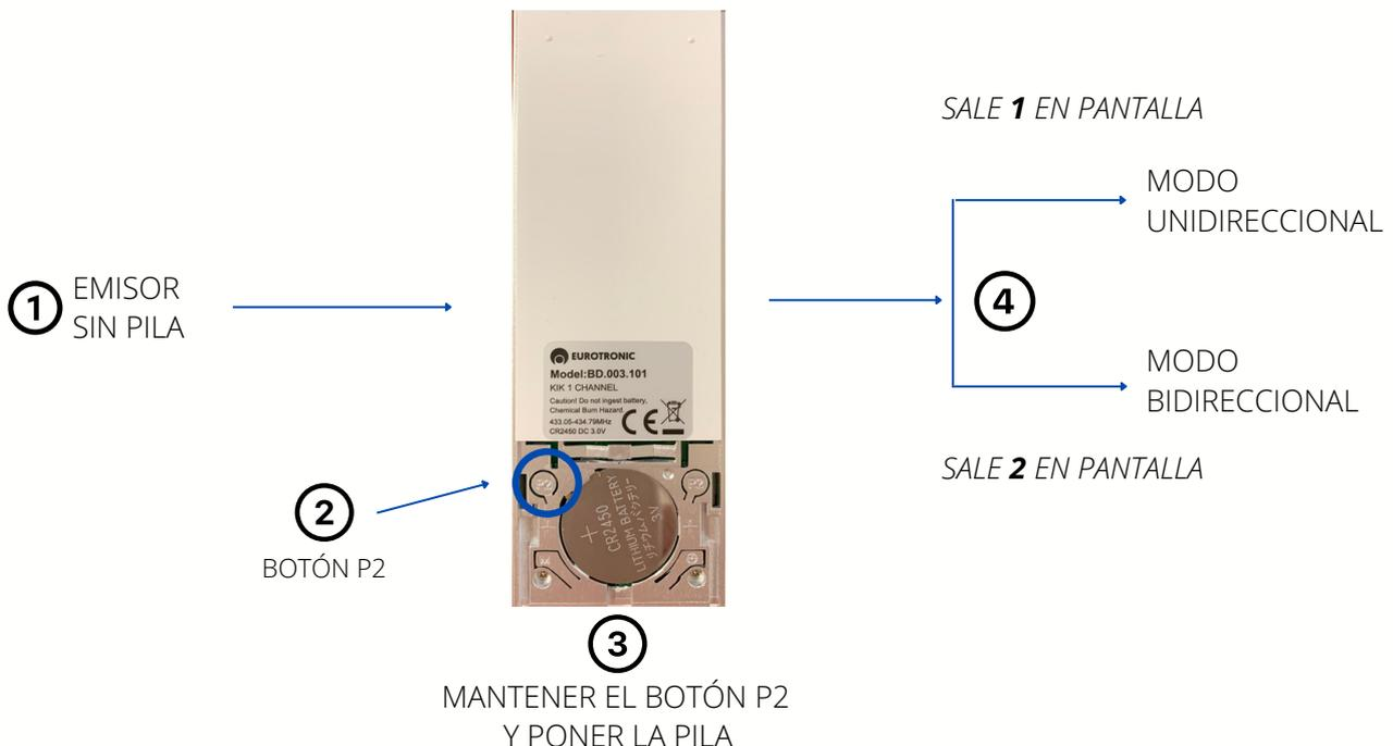
**Nota: El mando por defecto viene de fabrica con el modo Bidireccional. Aplicar el siguiente proceso para cambiar a Unidireccional.**
